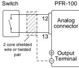
Pin12 $\rightarrow$  Switch Pin13 $\rightarrow$  Switch
