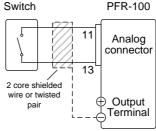
Pin11 $\rightarrow$  Switch Pin13 $\rightarrow$  Switch
