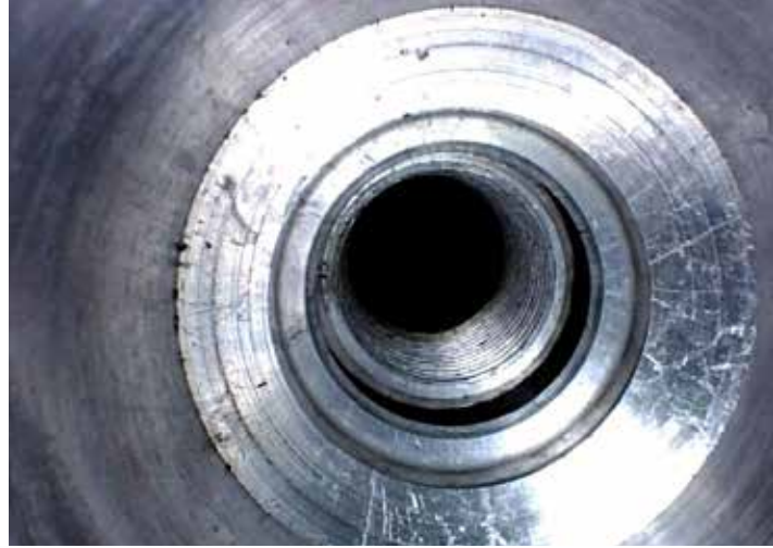
Yukarıdaki fotoğraf: Buji bağlantı noktası incelemesi
