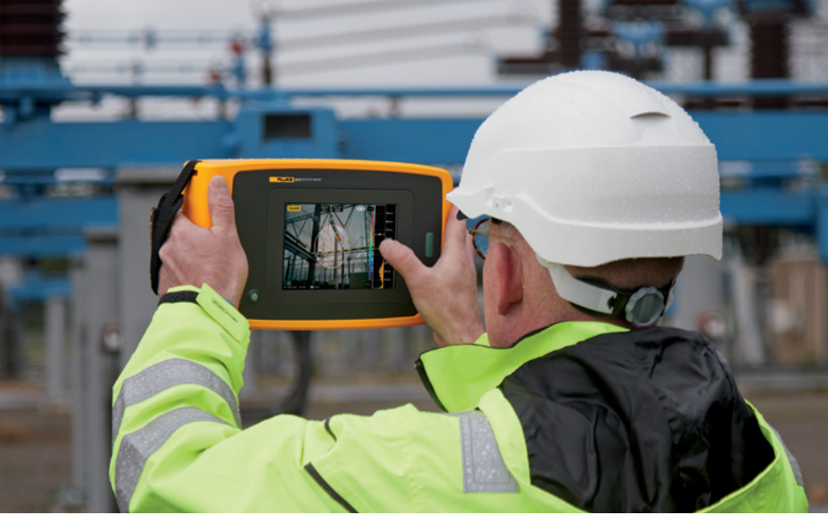
ii910 Hassas Akustik Görüntüleme Cihazı ile çekilen görüntüde, yüksek gerilimli bir uygulamada kısmi deşarjın algılanması yer almaktadır.
